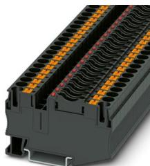
Sicherungsreihenklemme, Art der Sicherung: Flach, Sicherungstyp: Typ-C / max. 2,2 W, Nennspannung: 24 V, Nennstrom: 25 A, Anschlussart: Push-in-Anschluss, Bemessungsquerschnitt: 6 mm<sup>2</sup>, Querschnitt: 0,5 mm<sup>2</sup>- 10 mm<sup>2</sup>, Montageart: NS 35/7,5, NS 35/15, Farbe: schwarz
