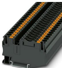
Sicherungsreihenklemme, Art der Sicherung: Flach, Sicherungstyp: Typ-C / max. 2,2 W, Nennspannung: 400 V, Nennstrom: 25 A, Anschlussart: Push-in-Anschluss, Bemessungsquerschnitt: 6 mm<sup>2</sup>, Querschnitt: 0,5 mm<sup>2</sup>- 10 mm<sup>2</sup>, Montageart: NS 35/7,5, NS 35/15, Farbe: schwarz
