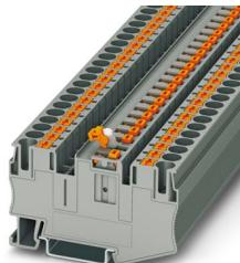
Messertrennklemme, Nennspannung: 500 V, Nennstrom: 20 A, Anschlussart: Push-in-Anschluss, Bemessungsquerschnitt: 6 mm<sup>2</sup>, Querschnitt: 0,5 mm<sup>2</sup> - 10 mm<sup>2</sup>, Montage: NS 35/7,5, NS 35/15, Farbe: grau
