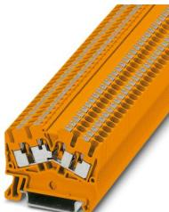
Durchgangsklemme, Nennspannung: 800 V, Nennstrom: 24 A, Anzahl der Anschlüsse: 4, Anschlussart: Push-in-Anschluss, Bemessungsquerschnitt: 2,5 mm<sup>2</sup>, 1. Etage, Querschnitt: 0,14 mm<sup>2</sup> - 4 mm<sup>2</sup>, Montageart: NS 35/7,5, NS 35/15, Farbe: orange
