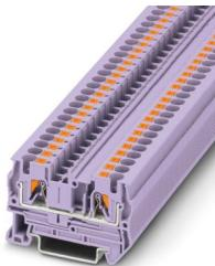
Durchgangsklemme, Nennspannung: 800 V, Nennstrom: 32 A, Anzahl der Anschlüsse: 2, Anschlussart: Push-in-Anschluss, Bemessungsquerschnitt: 4 mm<sup>2</sup>, Querschnitt: 0,2 mm<sup>2</sup> - 6 mm<sup>2</sup>, Montageart: NS 35/7,5, NS 35/15, Farbe: violett
