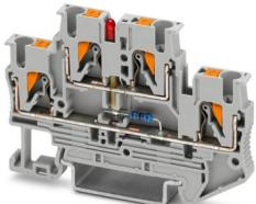
Doppelstockklemme, Die Betriebsspannung wird durch die Leuchtanzeige-Variante bestimmt. Kenndaten LED 12 V DC ... 30 V DC, 0,7 mA ... 2,4 mA, Nennspannung: 500 V, Nennstrom: 20 A, Anschlussart: Push-in-Anschluss, Bemessungsquerschnitt: 2,5 mm<sup>2</sup>, Querschnitt: 0,14 mm<sup>2</sup> - 4 mm<sup>2</sup>, Montage: NS 35/7,5, NS 35/15, Farbe: grau
