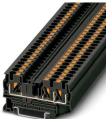
Durchgangsklemme, Nennspannung: 800 V, Nennstrom: 32 A, Anzahl der Anschlüsse: 3, Anschlussart: Push-in-Anschluss, Bemessungsquerschnitt: 4 mm<sup>2</sup>, Querschnitt: 0,2 mm<sup>2</sup> - 6 mm<sup>2</sup>, Montageart: NS 35/7,5, NS 35/15, Farbe: schwarz
