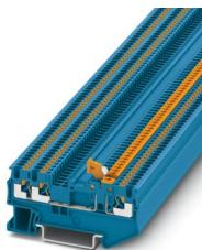
Messertrennklemme, Nennspannung: 400 V, Nennstrom: 10 A, 1. Etage, Anschlussart: Push-in-Anschluss, Bemessungsquerschnitt: 1,5 mm<sup>2</sup>, Querschnitt: 0,14 mm<sup>2</sup> - 1,5 mm<sup>2</sup>, Montage: NS 35/7,5, NS 35/15, Farbe: blau
