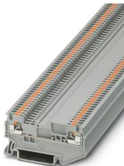
Durchgangsreihenklemme, konturgleich zur Trennklemme, Nennspannung: 400 V, Nennstrom: 17,5 A, 1. Etage, Anschlussart: Push-in-Anschluss, Bemessungsquerschnitt: 1,5 mm<sup>2</sup>, Querschnitt: 0,14 mm<sup>2</sup> - 1,5 mm<sup>2</sup>, Montage: NS 35/7,5, NS 35/15, Farbe: grau
