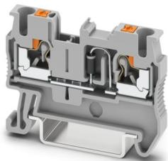
Bauelementreihenklemme, Der max. Strom wird durch die Diode bestimmt. Eingebaut: Diode 1N4007, Sperrspannung: 1300 V, Dauergrenzstrom: 0,5 A., mit integrierter Diode 1N4007, Nennstrom: 0,5 A, Anschlussart: Push-in-Anschluss, Bemessungsquerschnitt: 2,5 mm<sup>2</sup>, Querschnitt: 0,14 mm<sup>2</sup> - 4 mm<sup>2</sup>, Montage: NS 35/7,5, NS 35/15, Farbe: grau
