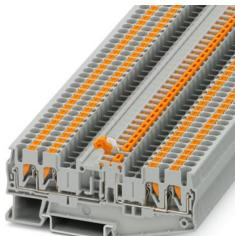
Messertrennklemme, Nennspannung: 400 V, Nennstrom: 16 A, Anschlussart: Push-in-Anschluss, Bemessungsquerschnitt: 2,5 mm<sup>2</sup>, Querschnitt: 0,14 mm<sup>2</sup> - 4 mm<sup>2</sup>, Montage: NS 35/7,5, NS 35/15, Farbe: grau
