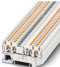
Durchgangsklemme, Nennspannung: 800 V, Nennstrom: 24 A, Anzahl der Anschlüsse: 4, Anschlussart: Push-in-Anschluss, Bemessungsquerschnitt: 2,5 mm<sup>2</sup>, Querschnitt: 0,14 mm<sup>2</sup> - 4 mm<sup>2</sup>, Montageart: NS 35/7,5, NS 35/15, Farbe: weiß
