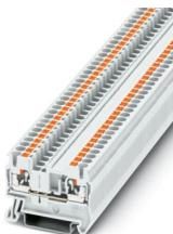
Durchgangsklemme, Nennspannung: 800 V, Nennstrom: 24 A, Anzahl der Anschlüsse: 2, Polzahl: 1, Anschlussart: Push-in-Anschluss, Bemessungsquerschnitt: 2,5 mm<sup>2</sup>, Querschnitt: 0,14 mm<sup>2</sup> - 4 mm<sup>2</sup>, Montageart: NS 35/7,5, NS 35/15, Farbe: weiß
