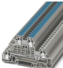
Installationsetagenklemme, Nennspannung: 400 V, Nennstrom: 38 A, Schraubanschluss, 1. und 2. Etage, Bemessungsquerschnitt: 6 mm<sup>2</sup>, Querschnitt: 0,2 mm<sup>2</sup> - 10 mm<sup>2</sup>, Montageart: NS 35/7,5, NS 35/15, Farbe: grau
