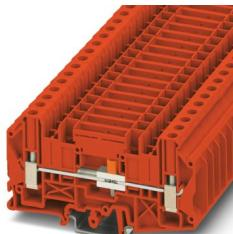
Trennklemme, Nennspannung: 1000 V, Nennstrom: 41 A, Anschlussart: Schraubanschluss, 1. Etage, Bemessungsquerschnitt: 6 mm<sup>2</sup>, Querschnitt: 0,2 mm<sup>2</sup> - 10 mm<sup>2</sup>, Montageart: NS 35/7,5, NS 35/15, NS 32, Farbe: rot
