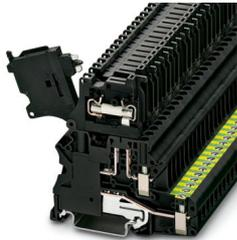
Sicherungsreihenkleme, Art der Sicherung: Glas / Keramik / ..., Sicherungstyp: G / 5 x 20, Nennspannung: 24 V, Nennstrom: 6,3 A, Anschlussart: Schraubanschluss, Bemessungsquerschnitt: 4 mm<sup>2</sup>, Querschnitt: 0,14 mm<sup>2</sup>- 6 mm<sup>2</sup>, Montageart: NS 35/7,5, NS 35/15, Farbe: schwarz
