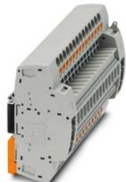
Prüfsteckleiste, Nennspannung: 400 V, Anzahl der Anschlüsse: 28, Polzahl: 14, Anschlussart: Push-in-Anschluss, Bemessungsquerschnitt: 6 mm<sup>2</sup>, 1. Etage, Querschnitt: 0,5 mm<sup>2</sup> - 10 mm<sup>2</sup>, Montageart: NS 35/7,5, NS 35/7,5, Farbe: grau
