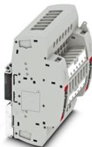
Prüfsteckleiste, VDE kodiert Typ B7, Nennspannung: 400 V, Anzahl der Anschlüsse: 14, Polzahl: 7, Anschlussart: Schraubanschluss, Bemessungsquerschnitt: 6 mm<sup>2</sup>, 1. Etage, Querschnitt: 0,2 mm<sup>2</sup> - 10 mm<sup>2</sup>, Montageart: NS 35/7,5, NS 35/15, Farbe: grau
