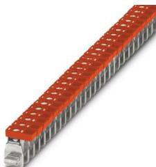
Anschlussklemme, Nennspannung: 300 V, Nennstrom: 76 A, Anschlussart: Schraubanschluss, Bemessungsquerschnitt: 16 mm<sup>2</sup>, Querschnitt: 1,5 mm<sup>2</sup> - 16 mm<sup>2</sup>, Montage: N-Sammelschiene, Farbe: rot
