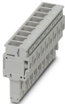
Stecker, Nennspannung: 1000 V, Nennstrom: 41 A, Polzahl: 9, Anschlussart: Schraubanschluss, Bemessungsquerschnitt: 6 mm<sup>2</sup>, Querschnitt: 0,2 mm<sup>2</sup>- 6 mm<sup>2</sup>, Farbe: grau
