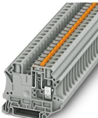
Messertrennklemme, mit Betätigungslasche und Prüfbuchsenschrauben zur Aufnahme von Prüfsteckern, Nennspannung: 500 V, Nennstrom: 20 A, Anschlussart: Schraubanschluss, Bemessungsquerschnitt: 2,5 mm<sup>2</sup>, Querschnitt: 0,2 mm<sup>2</sup> - 10 mm<sup>2</sup>, Montage: NS 35/7,5, NS 35/15, Farbe: grau
