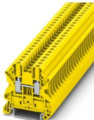
Durchgangsklemme, Nennspannung: 1000 V, Nennstrom: 32 A, Anzahl der Anschlüsse: 2, Anschlussart: Schraubanschluss, Bemessungsquerschnitt: 4 mm<sup>2</sup>, Querschnitt: 0,14 mm<sup>2</sup> - 6 mm<sup>2</sup>, Montageart: NS 35/7,5, NS 35/15, Farbe: gelb
