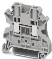
Durchgangsklemme, mit herausbrechbarer Trennwand im Brückenschacht, Nennspannung: 1000 V, Nennstrom: 32 A, Anzahl der Anschlüsse: 2, Polzahl: 1, Anschlussart: Schraubanschluss, Bemessungsquerschnitt: 4 mm<sup>2</sup>, Querschnitt: 0,14 mm<sup>2</sup> - 6 mm<sup>2</sup>, Montageart: NS 35/7,5, NS 35/15, Farbe: grau
