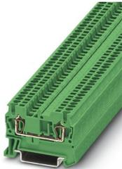
Durchgangsklemme, Nennspannung: 500 V, Nennstrom: 17,5 A, Anzahl der Anschlüsse: 2, Anschlussart: Zugfederanschluss, Bemessungsquerschnitt: 1,5 mm<sup>2</sup>, 1. Etage, Querschnitt: 0,08 mm<sup>2</sup> - 1,5 mm<sup>2</sup>, Montageart: NS 35/7,5, NS 35/15, Farbe: grün
