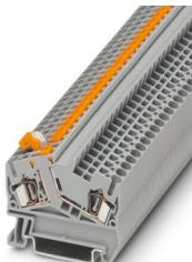
Messertrennklemme, Nennspannung: 400 V, Nennstrom: 20 A, 1. Etage, Anschlussart: Zugfederanschluss, Bemessungsquerschnitt: 2,5 mm<sup>2</sup>, Querschnitt: 0,08 mm<sup>2</sup> - 4 mm<sup>2</sup>, Montage: NS 35/7,5, NS 35/15, Farbe: grau
