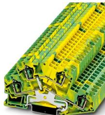
Schutzleiter-Doppelstockklemme, Anzahl der Anschlüsse: 4, Anschlussart: Zugfederanschluss, 1. und 2. Etage, Querschnitt: 0,08 mm<sup>2</sup> - 6 mm<sup>2</sup>, Montageart: NS 35/7,5, NS 35/15, Farbe: grün-gelb
