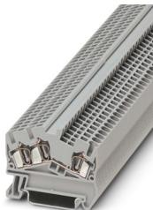
Durchgangsklemme, Nennspannung: 800 V, Nennstrom: 24 A, Anzahl der Anschlüsse: 3, Anschlussart: Zugfederanschluss, Bemessungsquerschnitt: 2,5 mm<sup>2</sup>, 1. Etage, Querschnitt: 0,08 mm<sup>2</sup> - 4 mm<sup>2</sup>, Montageart: NS 35/7,5, NS 35/15, Farbe: grau
