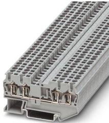
Durchgangsklemme, Nennspannung: 800 V, Nennstrom: 24 A, Anzahl der Anschlüsse: 4, Anschlussart: Zugfederanschluss, Bemessungsquerschnitt: 2,5 mm<sup>2</sup>, Querschnitt: 0,08 mm<sup>2</sup> - 4 mm<sup>2</sup>, Montageart: NS 35/7,5, NS 35/15, Farbe: grau
