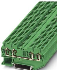
Durchgangsklemme, Nennspannung: 500 V, Nennstrom: 17,5 A, Anzahl der Anschlüsse: 4, Anschlussart: Zugfederanschluss, Bemessungsquerschnitt: 1,5 mm<sup>2</sup>, 1. Etage, Querschnitt: 0,08 mm<sup>2</sup> - 1,5 mm<sup>2</sup>, Montageart: NS 35/7,5, NS 35/15, Farbe: grün
