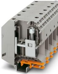
Hochstromklemme, Nennspannung: 1000 V, Nennstrom: 309 A, Anzahl der Anschlüsse: 2, Anschlussart: Schraubanschluss, Bemessungsquerschnitt: 150 mm<sup>2</sup>, Querschnitt: 35 mm<sup>2</sup> - 150 mm<sup>2</sup>, Montageart: NS 35/15, NS 32, Farbe: grau
