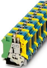
Installations-Schutzleiterklemme, Nennspannung: 400 V, Nennstrom: 101 A, Schraubanschluss, Querschnitt: 2,5 mm<sup>2</sup> - 25 mm<sup>2</sup>, Montageart: NS 35/7,5, NS 35/15, NS 32, Farbe: grün-gelb-blau
