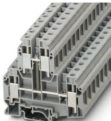
Doppelstockklemme, mit Potenzialverbinder, Nennspannung: 500 V, Nennstrom: 57 A, Anschlussart: Schraubanschluss, 1. und 2. Etage, Bemessungsquerschnitt: 10 mm<sup>2</sup>, Querschnitt: 0,5 mm<sup>2</sup> - 16 mm<sup>2</sup>, Bemessungsquerschnitt: 10 mm<sup>2</sup>, Montageart: NS 35/7,5, NS 35/15, NS 32, Farbe: grau
