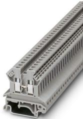
Durchgangsklemme, Nennspannung: 800 V, Nennstrom: 24 A, Anzahl der Anschlüsse: 2, Anschlussart: Schraubanschluss, Bemessungsquerschnitt: 2,5 mm<sup>2</sup>, Querschnitt: 0,2 mm<sup>2</sup> - 4 mm<sup>2</sup>, Montageart: NS 35/7,5, NS 35/15, NS 32, Farbe: grau
