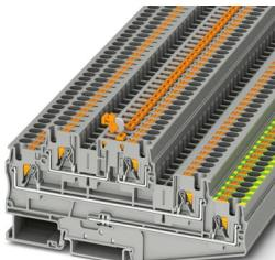
Trennklemme, Nennspannung: 500 V, Nennstrom: 30 A, Anschlussart: Push-in-Anschluss, Bemessungsquerschnitt: 4 mm<sup>2</sup>, Querschnitt: 0,2 mm<sup>2</sup> - 6 mm<sup>2</sup>, Anschlussart: Push-in-Anschluss, Bemessungsquerschnitt: 4 mm<sup>2</sup>, Querschnitt: 0,2 mm<sup>2</sup> - 6 mm<sup>2</sup>, Montage: NS 35/7,5, NS 35/15, Farbe: grau
