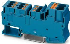
Potenzialsammelklemme, Nennspannung: 1000 V, Nennstrom: 57 A, Sammelanschluss, Anschlussart: Push-in-Anschluss, Bemessungsquerschnitt: 10 mm<sup>2</sup>, Querschnitt: 0,5 mm<sup>2</sup> - 16 mm<sup>2</sup>, Abgriff, Anschlussart: Push-in-Anschluss, Bemessungsquerschnitt: 4 mm<sup>2</sup>, Querschnitt: 0,5 mm<sup>2</sup> - 6 mm<sup>2</sup>, Montage: NS 35/7,5, Farbe: blau
