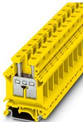
Durchgangsklemme, Nennspannung: 800 V, Nennstrom: 76 A, Anzahl der Anschlüsse: 2, Anschlussart: Schraubanschluss, Bemessungsquerschnitt: 16 mm<sup>2</sup>, Querschnitt: 2,5 mm<sup>2</sup> - 25 mm<sup>2</sup>, Montageart: NS 35/7,5, NS 35/15, NS 32, Farbe: gelb
