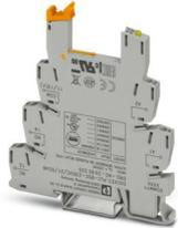
6,2 mm PLC-Grundklemme gegen Störströme bzw. Störspannungen auf der Steuerseite mit Schraubanschluss, ohne Relais- oder Solid-State-Relaisbestückung, zur Montage auf Tragschiene NS 35/7,5, mit integriertem RCZ-Filter, 1 Wechsler, Eingangsspannung 230 V AC
