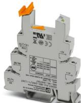
14 mm PLC-Grundklemme für Ausgabefunktionen mit Schraubanschluss, ohne Relais- oder Solid-State-Relaisbestückung, zur Montage auf Tragschiene NS 35/7,5, mit Lastrückleiteranschluss (BB), 2 Schließer (1-1), Eingangsspannung 24 V DC
