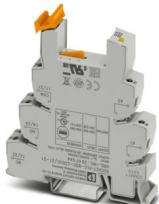
14 mm PLC-Grundklemme mit Schraubanschluss, ohne Relais- oder Solid-State-Relaisbestückung, zur Montage auf Tragschiene NS 35/7,5, 2 Wechsler, Eingangsspannung 230 V AC/DC
