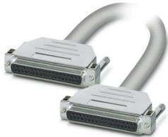
Konfektioniertes, geschirmtes, halogenfreies Rundkabel; Anschluss 1: D-SUB-Buchsenleiste (1x 37-polig); Anschluss 2: D-SUB-Buchsenleiste (1x 37-polig); Kabellänge: 6 m
