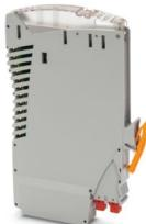
Ex ic-Speise- und Eingangstrennverstärker, HART für VIP I/O-Marshalling-Basiselemente: Überträgt 0/4 ... 20 mA-Signale aus dem Ex-Bereich (Zone 2, CID2) zu einer Bürde (aktiv oder passiv) in den sicheren Bereich. Galvanische 3-Wege-Trennung
