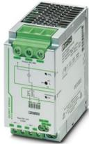
Aktives QUINT-Redundanzmodul zur Tragschienenmontage mit ACB Technology (Auto Current Balancing) und Überwachungsfunktionen, Eingang: 24 V DC / 2x 40 A, Ausgang: 24 V DC / 1 x 80 A, inkl. montiertem Universaltragschienenadapter UTA 107/30
