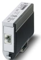
Überspannungsschutz gem. Class E<sub>A</sub> (CAT6<sub>A</sub>), für Gigabit-Ethernet (bis 10 GBit/s), Token Ring, FDDI/CDDI, ISDN, DS1. Geeignet für Power over Ethernet (PoE++ / 4PPoE) "Mode A" und "Mode B". RJ45-Zwischenstecker mit separater Erdungsleitung und Erdanschlussrastfuß für Tragschienen NS 35.
