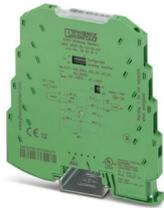
3-Wege-Trennverstärker zur galvanischen Trennung von Analogsignalen, über DIP-Schalter konfigurierbarer Ein-/Ausgang, mit Schraubanschluss, Standardkonfiguration
