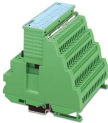
INTERBUS-ST-Digital-Eingabemodul, 32 Eingänge, 24 V DC, 2-Leiter-Anschlussstechnik, Schutzart IP20, bestehend aus: Klemmenteil mit Zugfederanschluss und Modulelektronik
