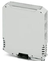
Tragschienengehäuse, Komplettgehäuse mit Metallfußriegel, hohe Bauform, mit Lüftungsschlitz, Breite: 22,6 mm, Höhe: 99 mm, Tiefe: 113,65 mm, Farbe: lichtgrau (ähnlich RAL 7035), Querverbindung: Tragschienen-Busverbinder (optional), Polzahl Querverbinder: 5
