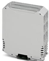
Tragschienengehäuse, Komplettgehäuse mit Metallfußriegel, hohe Bauform, mit Lüftungsschlitz, Breite: 35,2 mm, Höhe: 99 mm, Tiefe: 113,65 mm, Farbe: lichtgrau (ähnlich RAL 7035), Querverbindung: Tragschienen-Busverbinder (optional), Polzahl Querverbinder: 5
