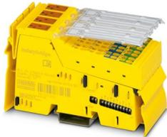
Sicherheitsgerichtetes digitales Ausgangsmodul, Schutzart IP20, für das SafetyBridge-System. Das Modul verfügt über 4 sichere digitale Ausgänge bei zweikanaliger Belegung oder 8 sichere digitale Ausgänge bei einkanaliger Belegung
