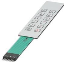
Folientastatur selbstklebend, Silberleittechnik, 12 Tasten, hochgeprägt, 3 Farben, Anschlusskabel: 88,5 mm, mit Crimp-Buchse female Rastermaß: 2,54 mm, Einsatztemperatur: - 20 °C ... 70 °C
