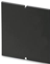
Seitenwand zur Verwendung mit Gehäusehalbschalen der Größe 125 x 87 mm; Wandstärke 2 mm; Gesamthöhe des Gehäuses 67 mm; Werkstoff Polycarbonat; Farbe schwarz ähnlich RAL 9005
